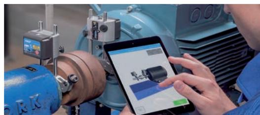
Parmi tous les produits de la gamme, l'outil d'alignement d'arbre laser est adapté à une très grande variété d'applications. Grâce à sa conception compacte et légère, à sa haute flexibilité de mesure et aux accessoires inclus, cet instrument peut être utilisé sur pratiquement toutes les machines, même dans les endroits difficiles d'accès.
